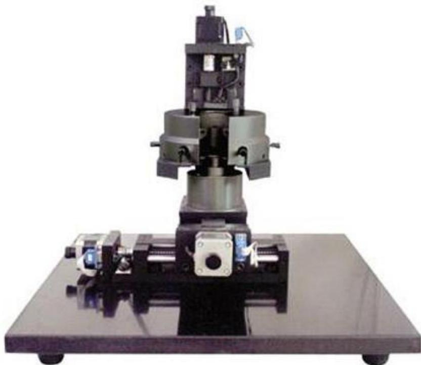
Skraćeni se nazivaju - ZSM. Slika se reproducira snimanjem interakcije sonde i površine koju ispituje. U suvremenom svijetu takvi mehanizmi omogućuju promatranje interakcije sonde s atomima. Razlučivost ZSM je usporediva s elektronskim mikroskopima, a još bolje u nekim parametrima.
