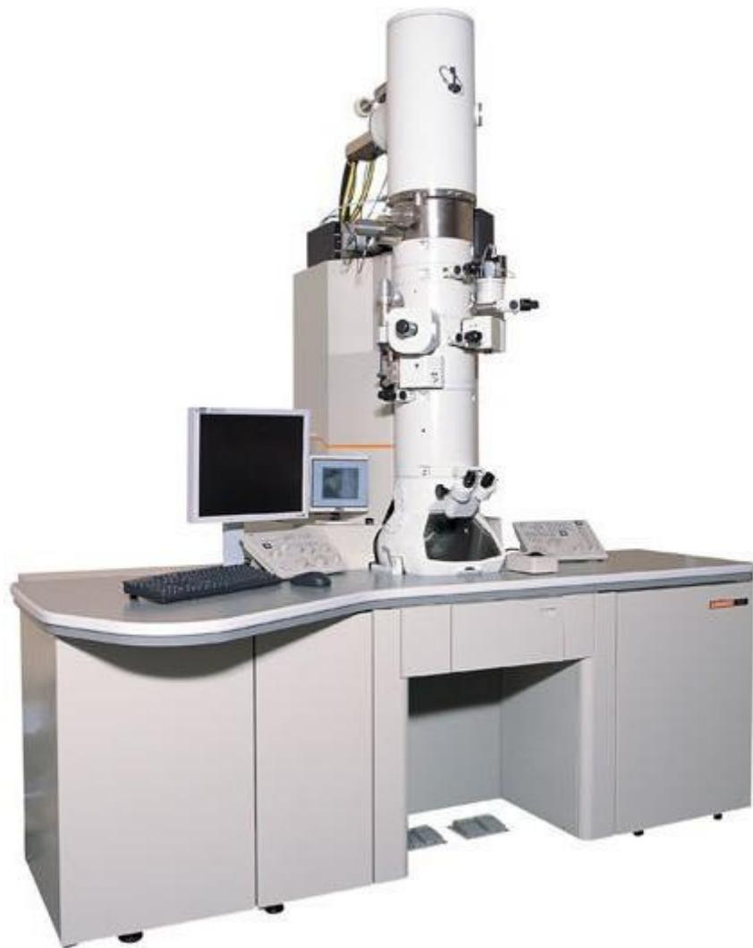
Elektron ima dugu valnu duljinu, koja ovisi o njezinom energetskom potencijalu:  $E = Ve$ , gdje je  $V$  vrijednost razlike potencijala,  $e$  je naboj elektrona. Valna duljina elektrona s prolaskom razlike potencijala jednaka 200000 V bit će oko 0,1 nm. Elektron se lako fokusira uz pomoć elektromagnetskih leća, što je uzrokovano njegovim nabojem. Nakon što se elektronska verzija slike prenese na vidljivo.
