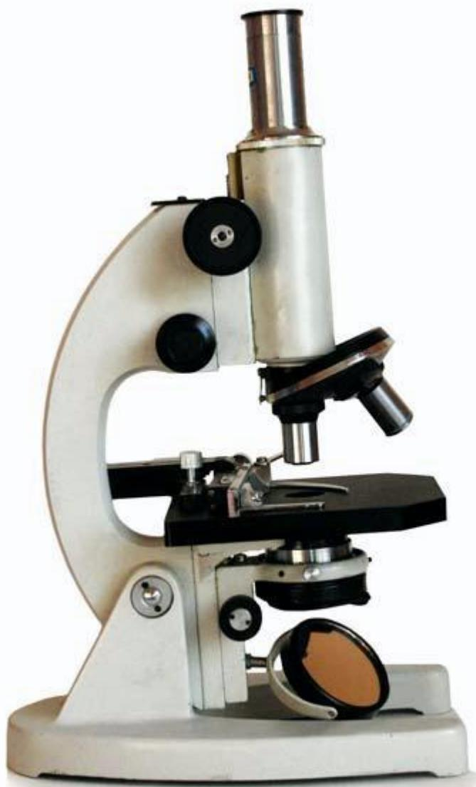
Povećanje je ukupna sposobnost mikroskopa da pokaže objekte koji se proučavaju u većim veličinama nego što doista jesu. Izračun ovog parametra može se izvršiti množenjem povećanja objektiva s okulara. Ova mogućnost u optičkim mikroskopima doseže 2000 puta, a elektron ima stotine puta više od svjetlosti.
